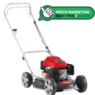
ROTORGRÄSKLIPPARE Silver 460 BR-A Bio Bioklippare med möjlighet till sidoutkast. Drivning på framhjulen. 46 cm klippbredd utrustad med modern toppventilmotor på 140 ccm samt quickstartsteknik. Tillverkad i Österrike. 700096442
