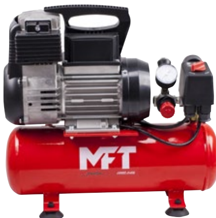
KOMPRESSOR 105/OF 1HK Avgiven luft 90 l/min vid 6 bar. Behållarens storlek: 5 L. Varvtal: 2800 v/min. Anpassad för dyckert- och klammerverktyg. Oljefri. Vikt 11,5 kg. 700067060
