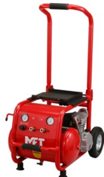
KOMPRESSOR 2520 OS Avgiven luftmängd 220 liter/min. Behållarens storlek: 20 L. 2,5 Hk, 230V. Anpassad för t.ex. olika typer av spikverktyg. Oljesmord. 700165431
